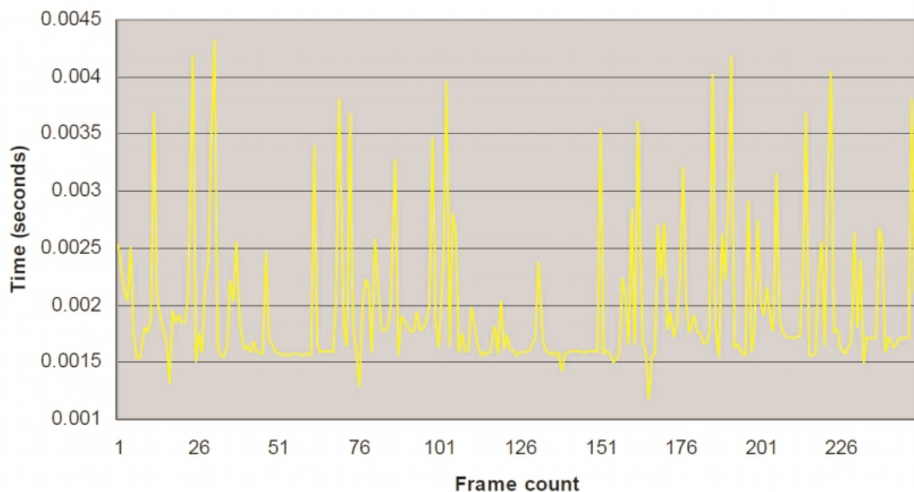
■ Abbildung 5: Function Callback Jitter für den zweiten Videostream, über 250 Bilder erfasst
