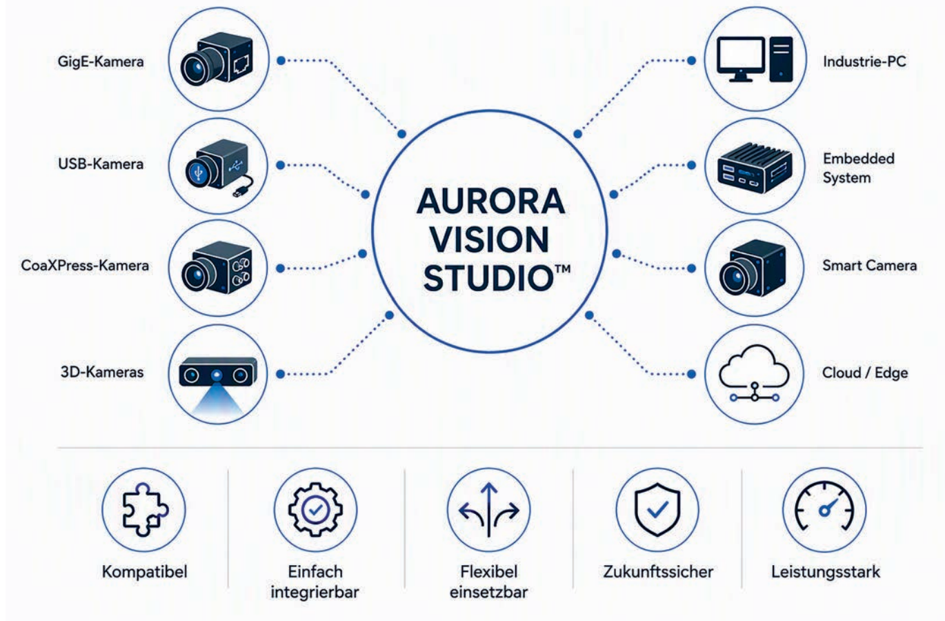
Bild 3 | Die grafische Entwicklungsumgebung Aurora Vision Studio ist durch ihre Kompatibilität zu USB3 Vision, GigE Vision und GenTL Hardware-unabhängig und erlaubt eine einfache Realisierung von Vision-Applikationen per Drag&Drop.
