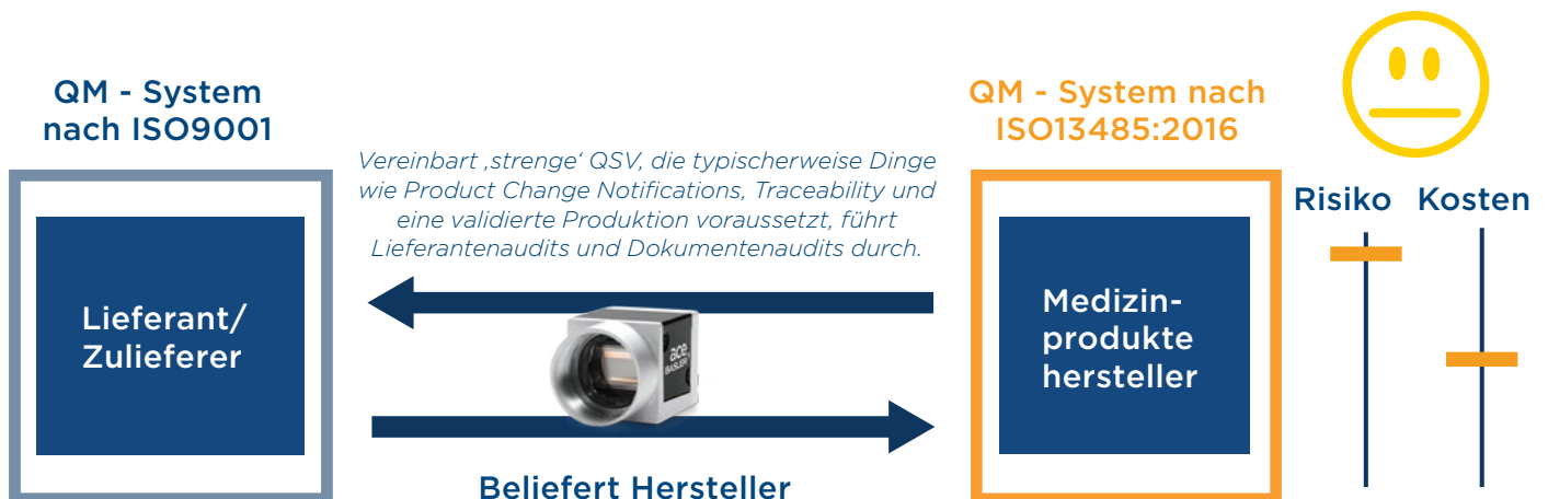
Abb. 4: Die Zusammenarbeit mit Lieferanten, die nach ISO9001 arbeiten, birgt geringere Kosten, aber ein höheres Risiko und Komplexität.
