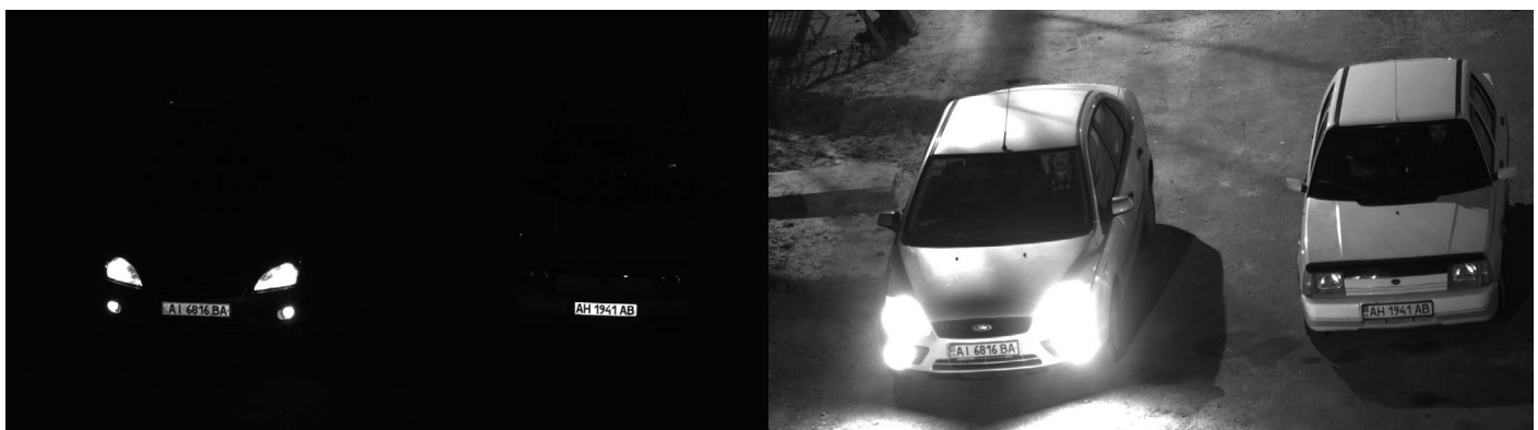
Abbildung 4: Ein Beispiel aus dem Bereich ITS: das Bild links wurde mit einem 4-Tap-CCD-Sensor, dem KAI4050 Sensor von ON Semiconductor (ehemals Kodak) aufgenommen. Das Bild rechts wurde mit dem neuen CMOS-Sensor IMX174 von Sony aufgenommen. Sehr gut ist der im rechten Bild deutlich höhere Dynamikumfang zu sehen, der es ermöglicht, sowohl den Fahrer als auch das Nummernschild im gleichen Bild besser zu erkennen. Zudem ist bei annähernd gleichen Einstellungen der Sensor deutlich empfindlicher, es sind entsprechend mehr Details im Hintergrund erkennbar.
