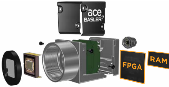
Abbildung 6: Kamera-Aufbau - Performance durch FPGA und RAM
