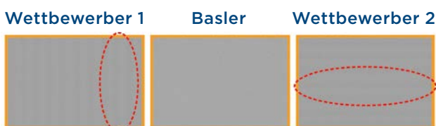
Abbildung 5: Ausschnittsvergrößerung des Testcharts – Rauschverhalten der einzelnen Kameras in mit 1,0 Lux beleuchteter Umgebung
