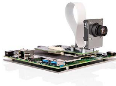
Abbildung 1: Embedded Vision System bestehend aus Snapdragon 820 Processing Board und Kameramodul mit BCON for MIPI-Schnittstelle
