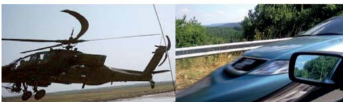
Abbildung 3: Der Rolling Shutter-Effekt. Bewegen sich die aufgenommenen Objekte, zeigen sich bei Sensoren mit Rolling Shutter teils merkwürdige Bewegungsartefakte.
