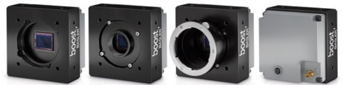
Abb. 1: Die Basler boost ist wahlweise erhältlich mit F-, C- oder M42-Mount. Das Koaxialkabel wird über einen Micro-BNC (HD-BNC) Stecker mit der Kamera verbunden und dient gleichzeitig der Datenübertragung und zur Spannungsversorgung; es ist somit nur ein Kabel nötig, was die Kabelführung und -organisation erleichtert.
